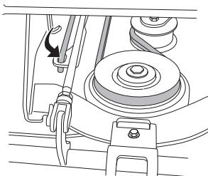
10 Закрепите прижимную пружину.
