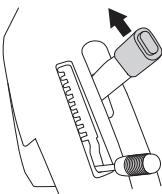
7 Вставьте устройство таким образом, чтобы внутренние направляющие касались дна пазов на раме оборудования.
